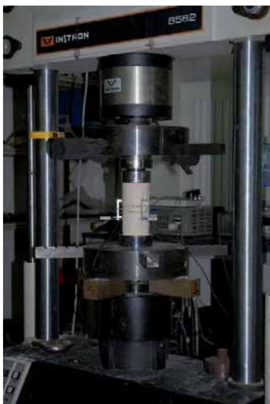
Figura 7 – Apparato sperimentale: (a) pressa elettro-meccanica INSTRON da 100 kN capace di eseguire prove in trazione/compressione in controllo di spostamento, deformazione o carico (si osservino i 3 DD1 resistivi con base 50 mm per la misura della deformazione assiale e per la determinazione del modulo elastico); (b) unità di controllo della pressa e di acquisizione-dati; e (c) provino strumentato.
