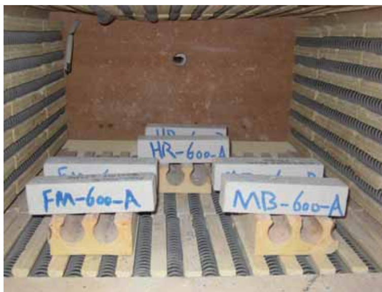
Figura 2 – Provini prismatici all'interno del forno elettrico, appena prima del ciclo termico con temperatura massima di 600°C.
