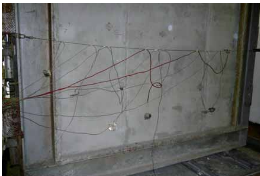
Figura 4 – Dettaglio tratto dalla foto precedente: si noti l'assenza di fessure passanti, e dunque la perfetta tenuta anche al termine della prova (durata della prova = 240 minuti).
