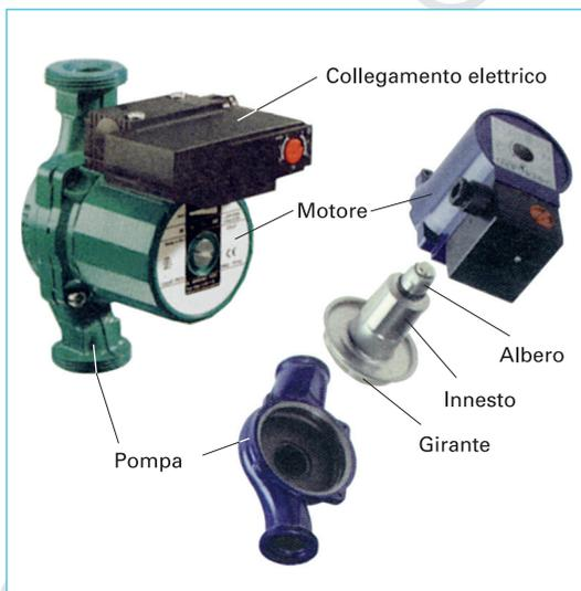
Figura 1: Pompa centrifuga per piccole portate
