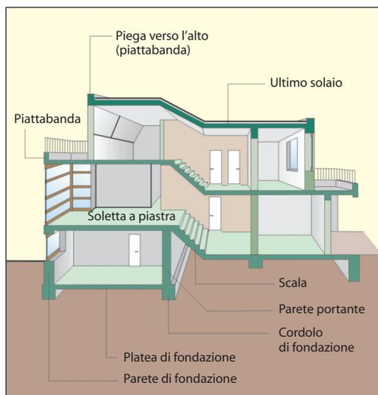
Figura 1: strutture in cemento armato.
