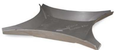
**Beton Up** è un accessorio del sistema Iglù® (o Atlantis) che **impedisce al calcestruzzo di formare pilastri**. In questo modo i casseri assumono la funzione di un semplice impalcato sul quale può essere realizzata una **soletta monolitica in calcestruzzo armato vincolata al contorno**. Con **Beton Up** il solaio non è autoportante.
