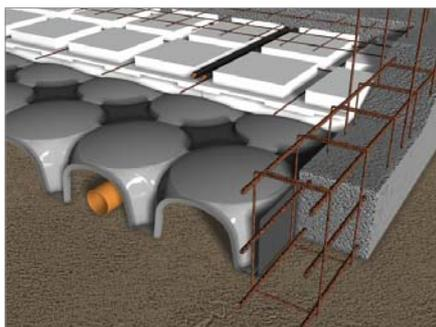
Iso Iglù® è un pannello di dimensioni 100 x 100 cm in polistirolo. Consente di realizzare una struttura a nervature incrociate in c.a. con appoggi al contorno (muri e fondazioni).
