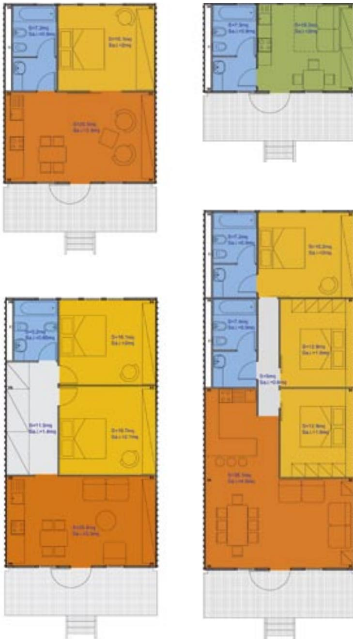
“L'Armadillo” è un piccolo spazio carenato di dimensioni pari a 6,60x8,00 m, frazionabile in sottounità di 6,60x4,00 m, oppure ampliabile in unità da 6,60x12,00 o 16,00 m, aggiungendo, al modulo base, una o due campate. Le configurazioni abitative sono molteplici sia per usi residenziali che per altre funzioni visto che all'interno della scocca la pianta è totalmente libera e viene quindi disegnata a seconda dell'esigenza dell'utente.
