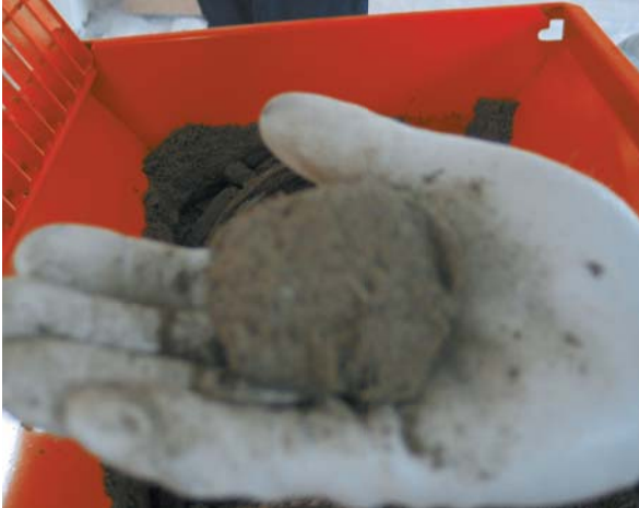
Il massetto impastato deve avere una consistenza "terra umida".
